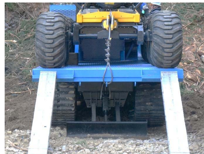
ブレード(排土板)の 大きさ取付位置検討
