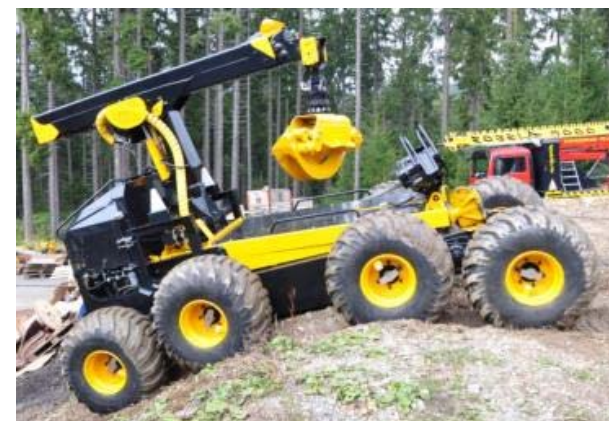
8輪・クレーン・クラムバンク
