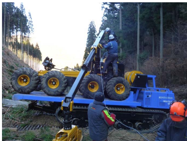
横取りウィンチの乱巻修復
